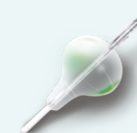
内視鏡レーザーアブレーションカテーテル バルーン内部からレーザーを照射し、心房細動の原因となる肺静脈からの異常興奮を隔離します。カテーテル内部の内視鏡で、正確な留置・焼灼が可能です。
