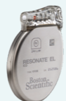
T-ICD 心臓の拍動が早まる不整脈(頻脈)のうち、致死性の不整脈である心室細動の発生を検知し、電気ショックを与え、拍動を正常な状態に戻します。
